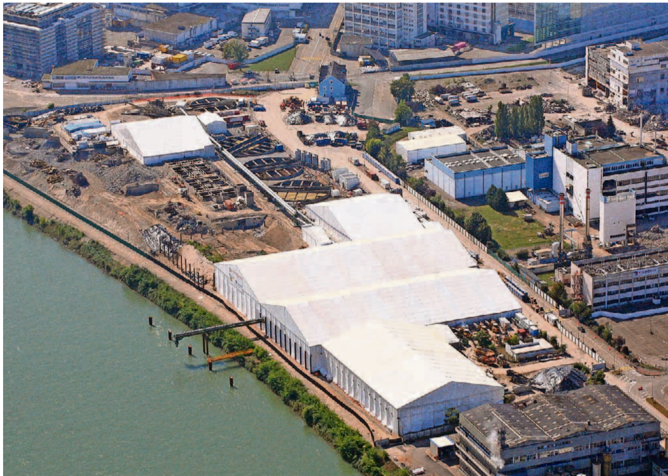
In den weissen Zelten wird die belastete Erde vor dem Weitertransport zwischengelagert.
